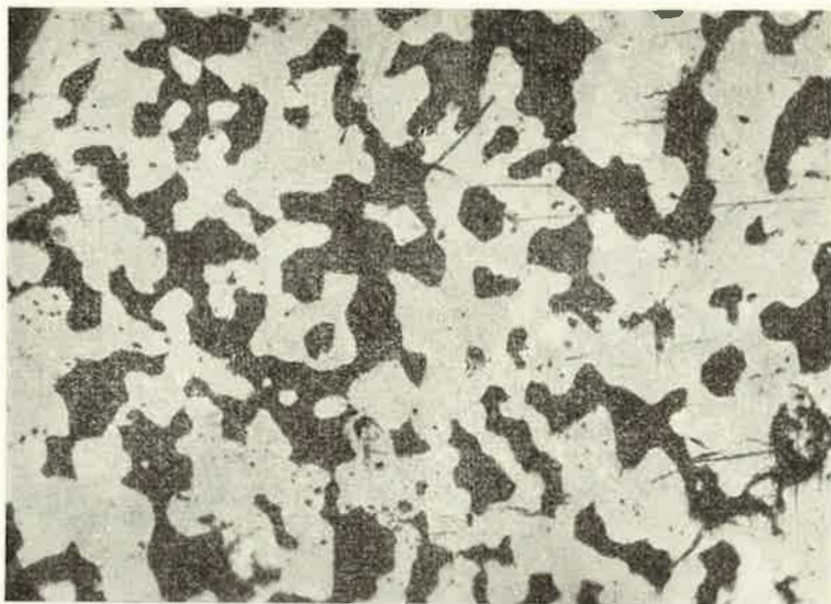
Figur 6. Polerprov av produkten vid försök n:o 116. 30 \times . Man ser att något mer än halva arealen upptages av den glänsande metallen. Den mörka mellanmassan är huvudsakligen olivin. Utgångsmaterial: Kiruna B-slig med tillsats av 17,7 % kimirök och 6 % \text{SiO}_2 . Upphettat till 1280^\circ i koldegel. Lineär krympning 42 %. Jämför sid. 45. Observera produktens kompaktitet och frihet från porer.
