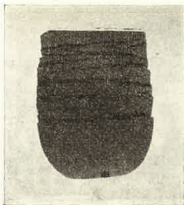
Figur 2. Ca naturlig storlek. Produkten bildar en avgjutning av smältdegeln och är avbildad från sidan för att krympningssprickor och förskjutningar skola bli synliga. Utgångsmaterial är »Cementsvart» med 10 % reduktionskol. Upphettningstemperaturen 1280°. Tunnelugn. Degelns diameter 3,5 cm, produktens 2,8 cm.
