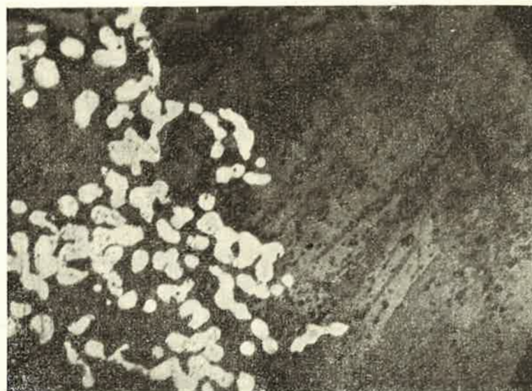
Figur 5. Polerprov av produkten vid försök n:o 28. 100 \times . Ljusa runda korn av metalliskt järn. Ljusare grå stora olivinkristaller i mörkare grått glas. Utgångsmaterial: »Cementsvart» med 10 % reduktionskol upphettat till ca 1300^\circ i tunnelugn.
